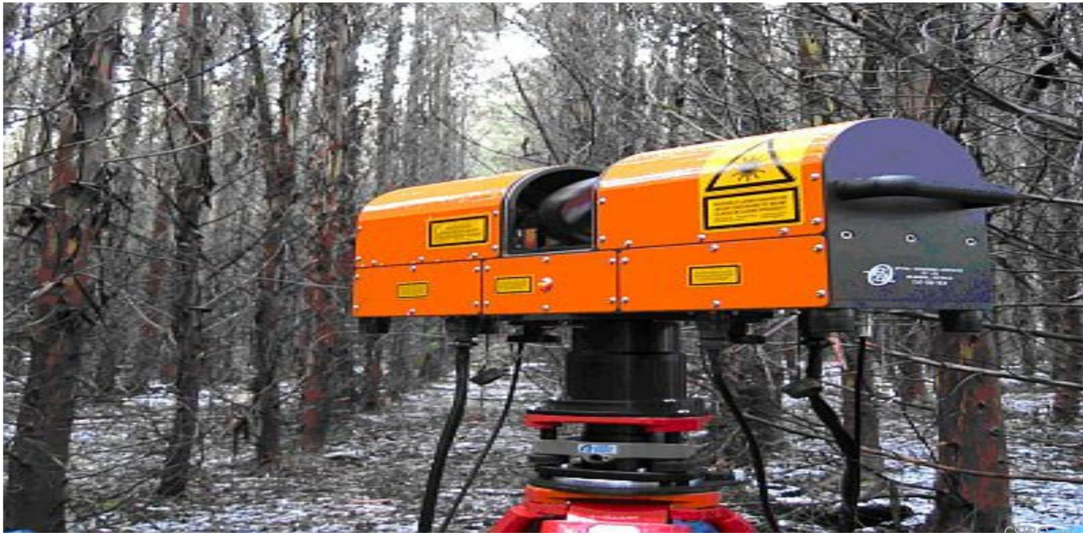
El sistema emite un pulso laser con cierta energía. La intensidad de retorno como función de la distancia es almacenada. Esta “waveform” entrega información de la densidad del bosque en todas las direcciones. Los datos colectados permiten realizar un medición rápida de un amplio rango de variables estructurales.
