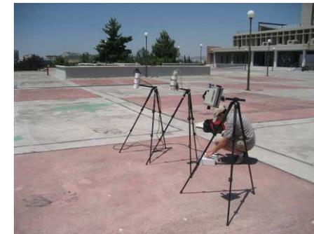
Calibración con mástiles fijos en suelo desnudo y hierba, medidas en agua
