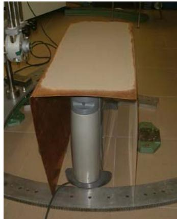
MEDIDA EN LABORATORIO DE SUELO DESNUDO, UTILIZANDO UN USO COMBINADO DEL MÉTODO DE LA CAJA Y EL ALGORITMO TES
